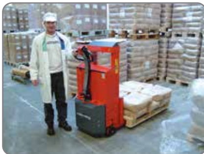
Óptima seguridad: pantalla transparente en el mástil. Velocidad de traslación reducida con las horquillas elevadas.
