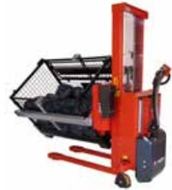
Pour le Rotator, les opérations de levage, de descente et de rotation sont contrôlées par télécommande filaire (mode standard). La télécommande sans fil pour les opérations de levage, de descente et de rotation est disponible en option.
