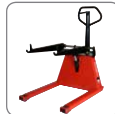
Étroits et courts, les longerons du gerbeur permettent une installation complète des bobines dans la machine.
