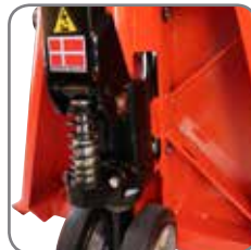
Un clapet de non-retour spécial permet d'assurer une descente contrôlée et un positionnement tout en douceur de la bobine.
