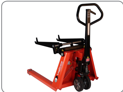
El elevador es compacto y muy manejable y asegura unas condiciones de trabajo ergonómicas para el operario.
