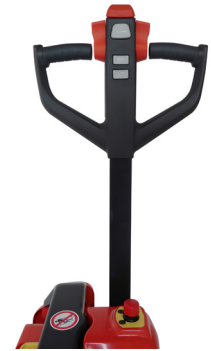
Timón ergonómico con superficies de agarre suaves. Regresa con suavidad a la posición vertical. Puede funcionar con el timón en posición vertical.
