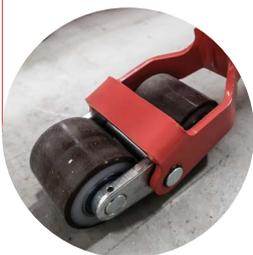
Tandemrollen vorne für mehr Stabilität und zur Vermeidung von Bremsspuren
